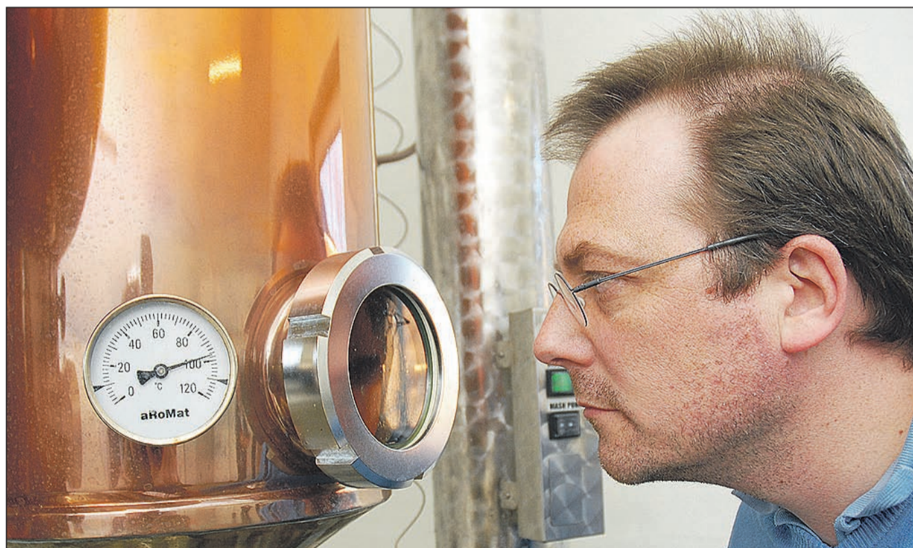
Det håndmedede destillationsapparat fra Tyskland inddamper 7-8 liter alkohol under en brænding, og Esben Moestrup kan se den klare fortættede væske bag et køje.
